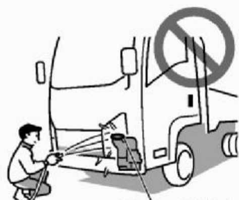
エアインテークダクト (空気取り入れ口)
